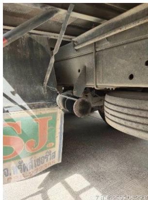
ภาพที่ 2-17 อุปกรณ์ดับเพลิงติดกับท่อนไอเสียรถยนต์
